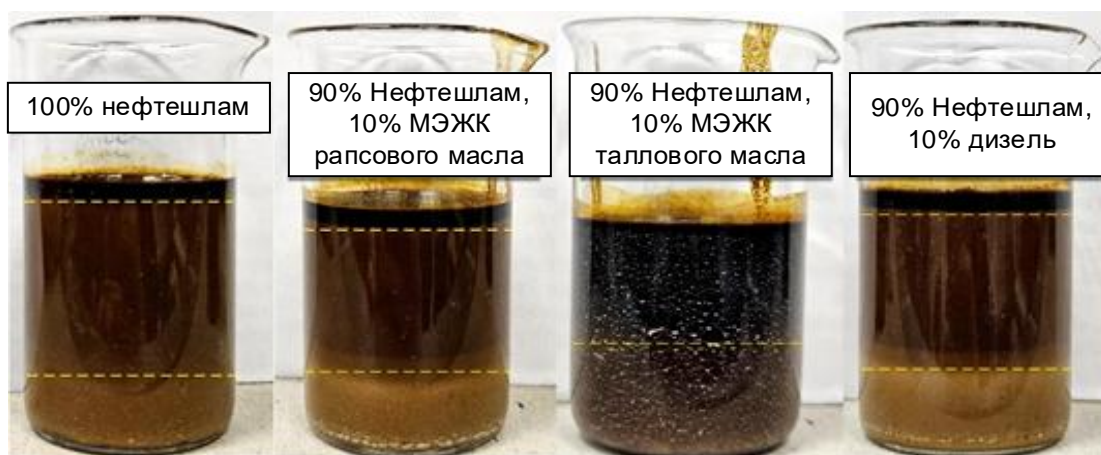
Рисунок 4.2 – Внешний вид топливных смесей на основе нефтешлама после статического хранения в течение 7 суток [112].
